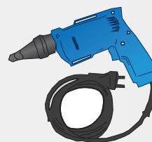
Bauschrauber, vorteilswise mit rastbarem Tiefenanschlag
