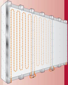
Es soll der gesamte Druckverlust  $\Delta p_{Ges}$  einer 6,25 m<sup>2</sup> ModulWand (Annahme 5 Stk. V020-100 an einem Heizkreis) ermittelt werden. Die gewünschte Vorlauf-/Rücklauf-temperatur beträgt 40/30 °C, daraus ergibt sich eine Wärmeabgabe von 111 W/m<sup>2</sup>. Erforderliche Raumtemperatur ist 20 °C. Der gesamte Druckverlust  $\Delta p_{Ges}$  setzt sich aus folgenden Komponenten zusammen:
