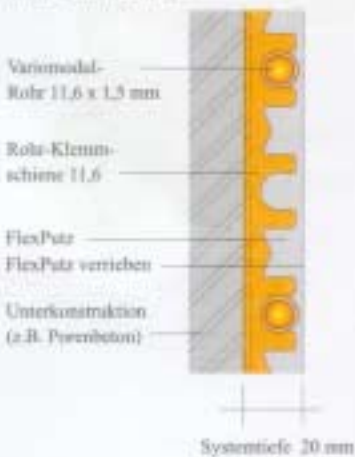
Schnitt durch das System Gestaltete Wärme mit FlexPutzoberfläche
