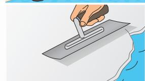
Über die Normtoleranzen hinausgehende Vertiefungen werden mit Bodenausgleichsmasse auf Calciumsulfat-Basis nach Kapitel 5.4 ausgeglichen.
