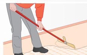
Innerhalb von 3 Stunden (bei 20 °C) nach Einbringen der Kompakt-Füllmasse wird eine 2. Schicht Kompakt-Füllmasse aufgebracht.
